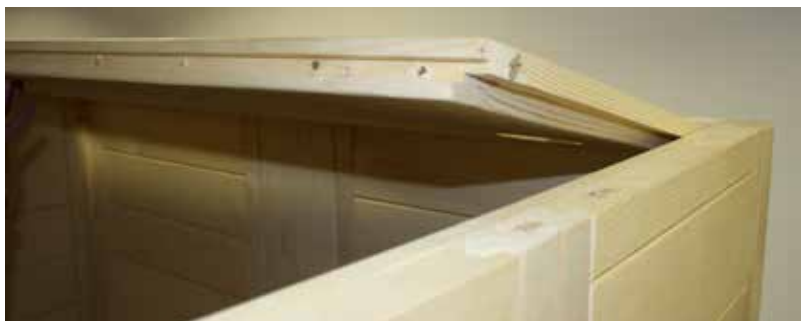
Fig. 18: Inserção dos elementos de teto da frente
