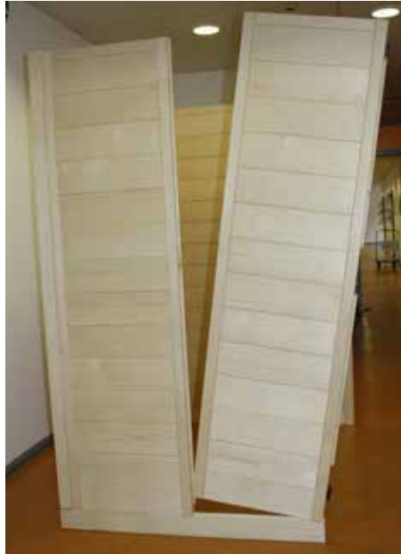
Fig. 9: Montagem dos dois suportes de canto frontais com ranhura para vidro
