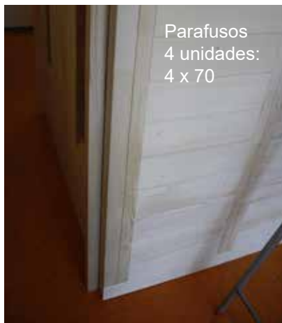
Fig. 52: Montagem das barras distanciadoras na parede traseira
