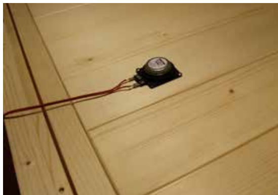
Fig. 47: Montagem do excitador
