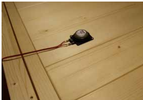
Fig. 47 : Montage des excitateurs
