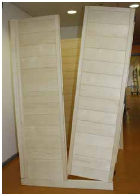
Fig. 9 : Montage des deux montants d'angle avant avec rainure pour verre
