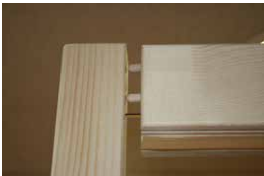
Fig. 13 : Montage de la barre pleine au-dessus de la façade en verre
