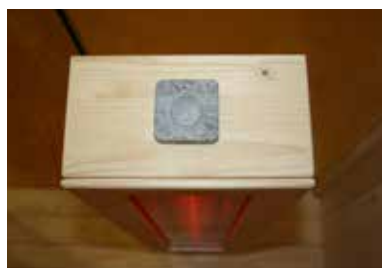
Fig. 31 : Insertion des coupelles en pierre ollaire
